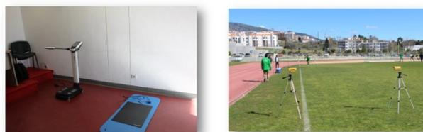
Figura 1. Instrumentos utilizados para a recolha de dados: (a) Balança de bioimpedância InBody 270 e Plataforma ChronoJump; (b) Dispositivo Microgate Timing System - Racetime 2.
