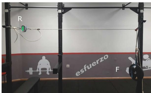
Figura 1. Ejemplo del funcionamiento de una polea fija. R, resistencia; F, fuerza.
